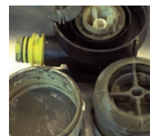
Zentrifugengehäuse, verkrustet - Totalausfall der Saugmaschine
