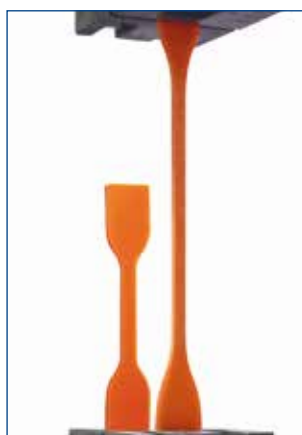
Dehnung von V-Posil X-Light Fast
